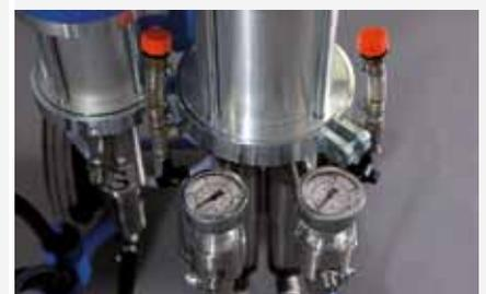
Druckmesseinheit und Ölschmierung
