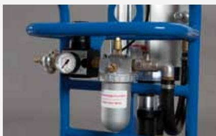
Druckminderer mit Manometer und Frostschutzeinrichtung
