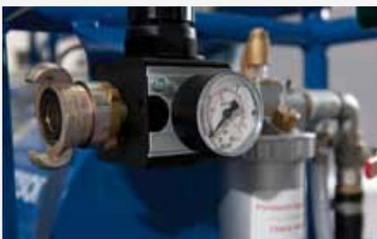
Druckminderer mit Manometer und Frostschutzeinrichtung
