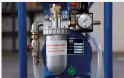
Druckminderer mit Manometer und Frostschutzeinrichtung
