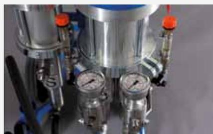
Druckmessseinheit und Ölschmierung
