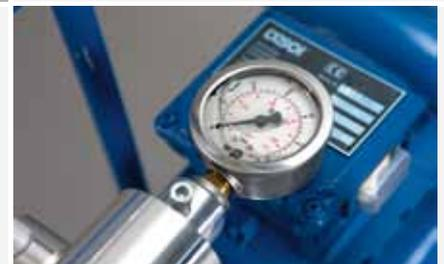
Druckmessereinheit mit Manometer
