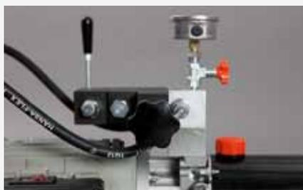
Handventil, stufenlose Druckreglung
