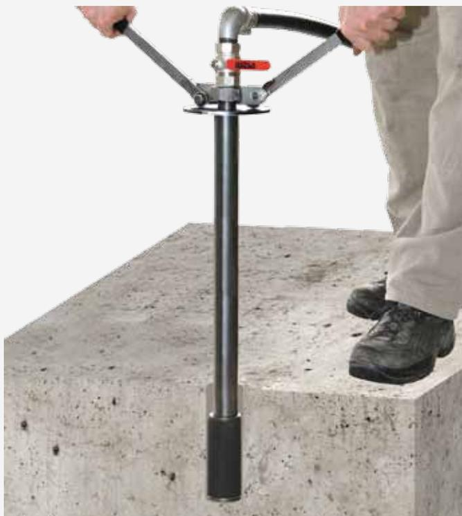
Der Schnellspannpacker wird für die Injektion unter Bauteilen, z. B.: unter Bodenplatten eingesetzt. Durch Betätigen der Hebelarme wird der Packer sicher gespannt, die Spannposition bleibt dabei erhalten.
