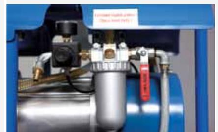
Druckminderer mit Manometer und Frostschutzeinrichtung
