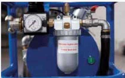
Druckminderer mit Manometer und Frostschutzeinrichtung
