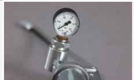
Druckmesseinheit mit Manometer
