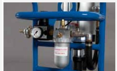
Druckminderer mit Manometer und Frostschutzeinrichtung
