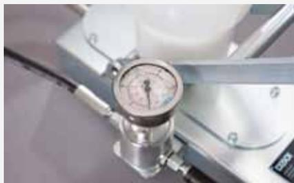
Druckmesseinheit mit Manometer
