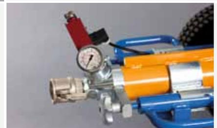
Druckschalter mit Manometer am Maschinenausgang
