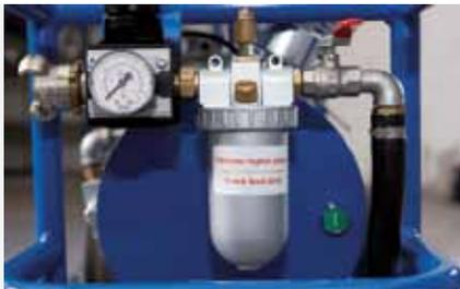
Druckminderer mit Manometer und Frostschutzeinrichtung
