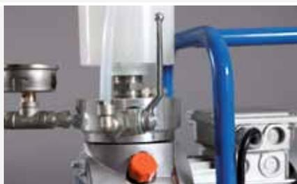
Rücklaufschlauch mit Kugelhahn
