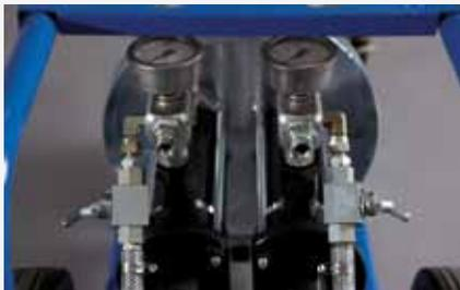
Druckmessereinheit mit Manometer
