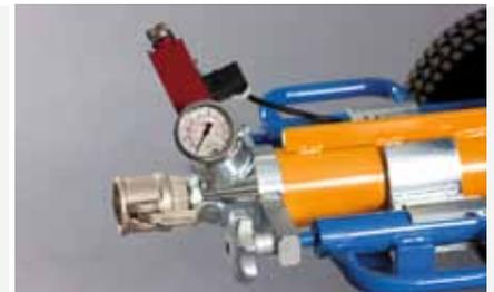
Druckschalter mit Manometer am Maschinenausgang
