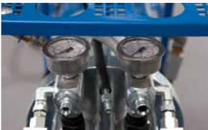
Druckmessereinheit mit Manometer
