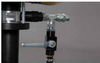
Rücklaufschlauch mit Kugelhahn
