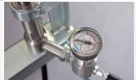
Manometer am Maschinenausgang
