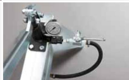
3-Wege Kugelhahn zum Spannen und Entspannen der Hydraulikpacker
