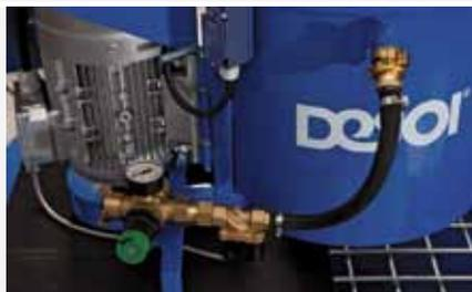
Druckminderer und Magnetventil
