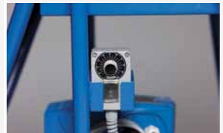
Fernbedienung mit stufenloser Fördermengenregulierung
