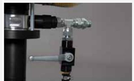
Rücklaufschlauch mit Kugelhahn
