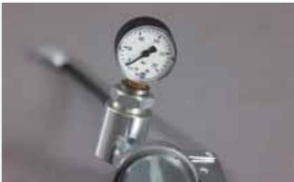
Druckmesseinheit mit Manometer
